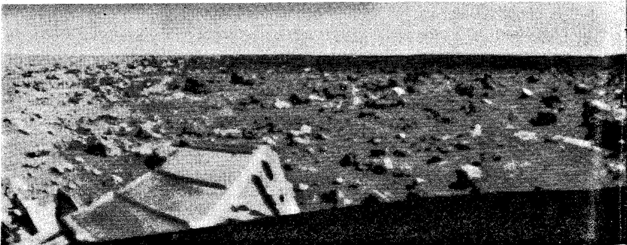
探査機は四千フィートの高度で切り離され、三個の逆噴射ロケットを作動させた。巨大な燃えるタイマツのような噴射は機体を減速させて、うまく軟着陸させた。しかし、この三個のロケットエンジンは数千度の高熱ばかりか莫大な推力を示している。この二つの要素は、接地前に着陸場所を完全に殺菌したばかりではなく、少なくとも周囲百フィートにわたって、生物学的に価値のある土を吹き飛ばしたのである。こんな地面で生命のシルシを発見できるだろうか。科学者もそう思つたのではないか。一方、あの小さなシャベルはその殺菌された土地を掘り続けて探索を続けているのである。
